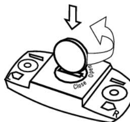
Um eine lange Lebensdauer zu ermöglichen, öffnen Sie die Abdeckung nur zum Wechseln der Batterie. Vergewissern Sie sich, dass der Dichtungsring nicht beschädigt ist. Sollte dies doch der Fall sein, tauschen Sie ihn bitte durch einen neuen aus.
