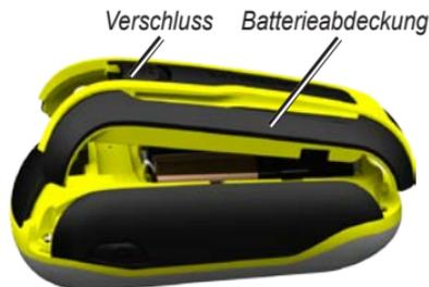
2. Legen Sie die Batterie ein. Richten Sie die Plus- und Minuskennzeichnungen (+ bzw. -) auf dem Gerät mit denen auf der Batterie aus.
