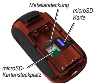
4. Um die microSD-Karte zu entfernen, heben Sie die Metallabdeckung an, und entnehmen Sie die Karte aus dem microSD-Kartensteckplatz.
